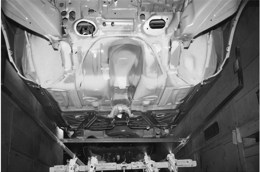
Figura 104 Aplicação, por filete, de massa para vedação de juntas da carroceria
