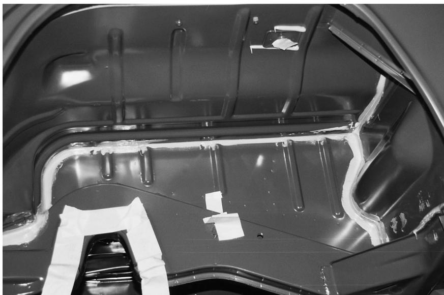
Uma vez aplicada a massa em todos os pontos necessários, a carroceria passa por uma estufa para fusão e consolidação da camada protetora.
