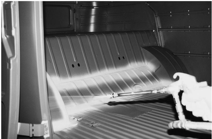
Figura 105 Aplicação, por pincelamento, de massa de vedação em juntas da carroceria
