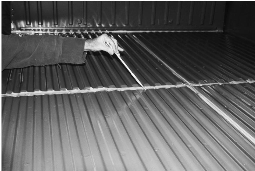
Figura 106 Interior do veículo após a aplicação da massa de vedação
