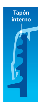
Vista de corte frontal izquierda de una tapa aplicada en el cuello
