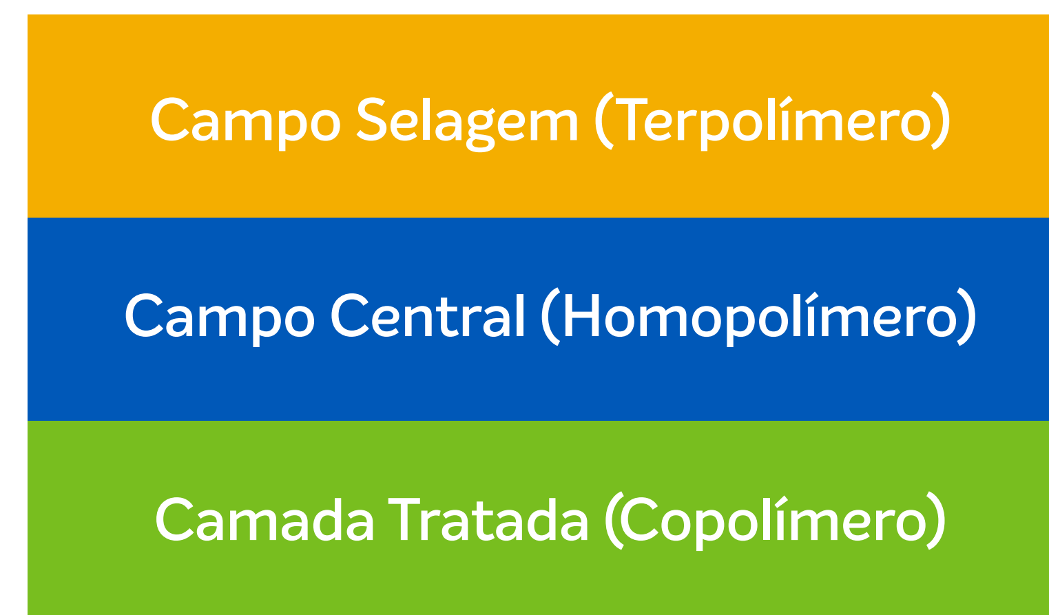
Figura 5 – Diagrama simplificado de uma construção exemplificada de filme BOPP
