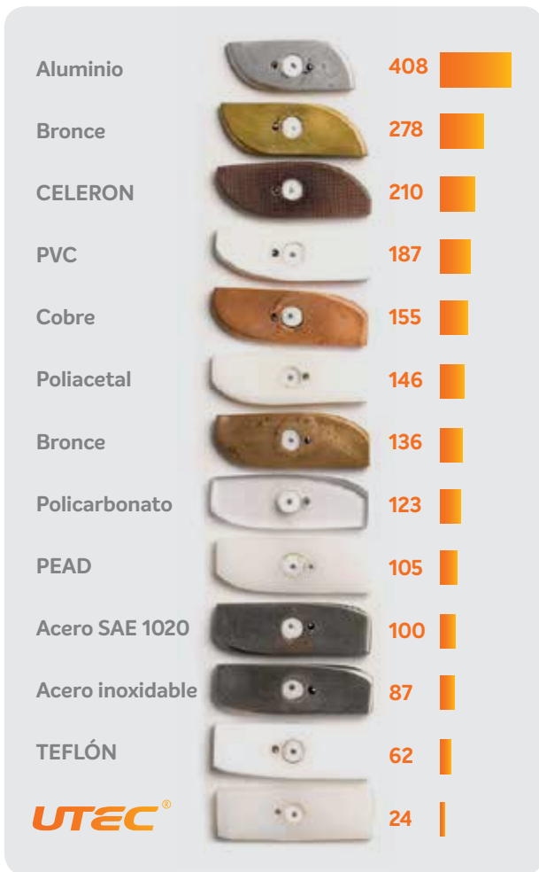
Figura 4 – Desgaste por abrasión relativo de los grados de UTEC y varios materiales, ACERO SAE 1020 = 100. Las imágenes muestran las piezas con las que se hicieron las pruebas. Medido por el método de lechada de arena interno de Braskem.
