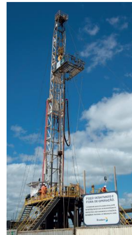
Sonda utilizada na verificação de integridade em poço de exploração de sal-gema da Braskem desativado
