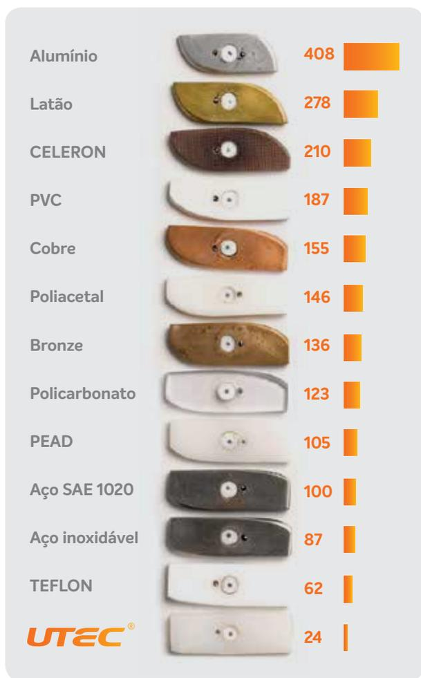
Figura 4 – Desgaste relativo por abrasão de grades UTEC e vários materiais, STEEL SAE 1020 = 100. As figuras mostram as peças testadas. Medido pelo método interno de lama com areia da Braskem.
